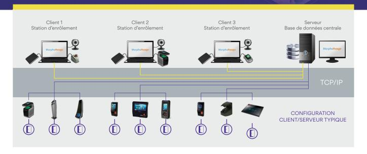
Enregistre les données biométriques (empreinte, réseau veineux/empreinte, visage) dans une seule base Encode les badges de type MIFARE®, DESFire® et iClass® Gère jusqu'à 100 000 utilisateurs et 5 000 terminaux biométriques Fonctionne de manière autonome ou intégrée avec des systèmes tiers de contrôle d'accès
